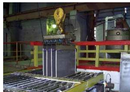
Рисунок 37. Промышленная установка для получения Со электролитическим способом. Выемка готовой продукции.
