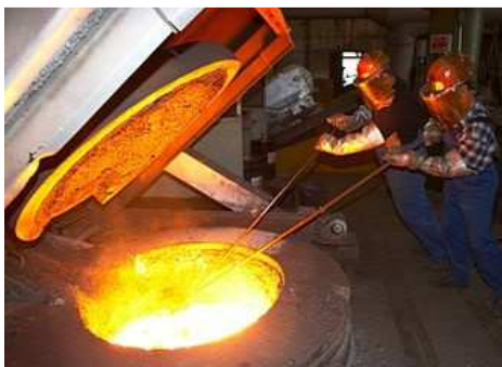
Рисунок 62. Плавка сплава в тигельной электропечи.
