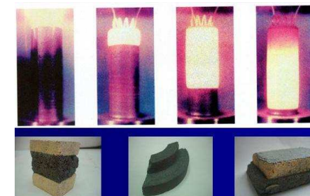
Рисунок 97. Последовательность этапов процесса СВС и получаемые конечные продукты
