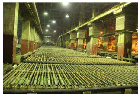
Рисунок 41. Электролизные ванны для промышленного получения порошков ПНЭ
