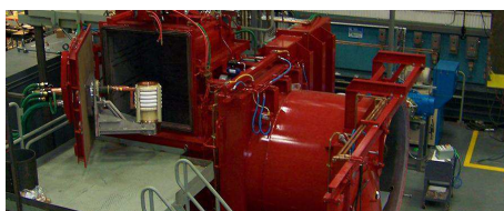
Рисунок 31. Электроиндукционная гарнисажная печь
