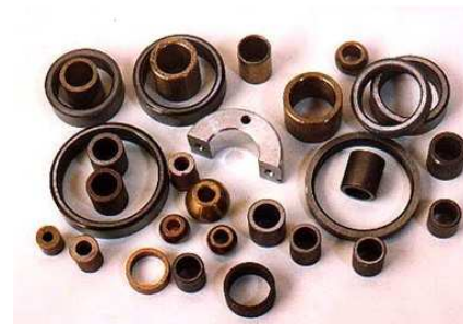
Рисунок 72. Образцы изделий из антифрикционных материалов
