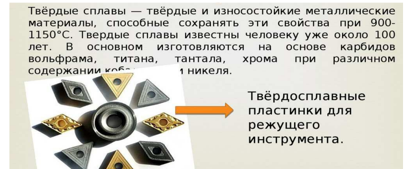
Рисунок 55. Определение твердых сплавов и образцы изделий из них
