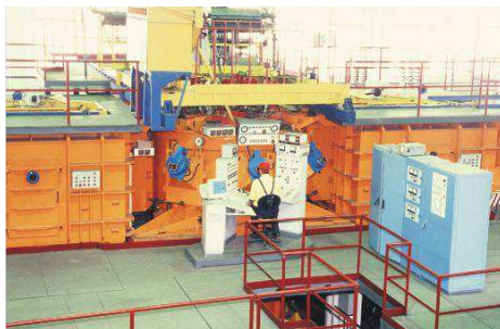
Рисунок 30. Плавильная печь электронно-лучевого типа
