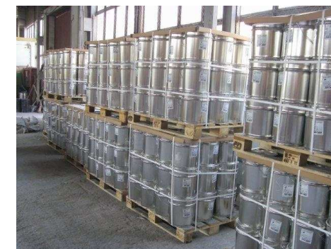
Рисунок 45. Стальные герметичные емкости с упакованным в них карбидом кальция, предварительно уложенным в заполняемые азотом полиэтиленовые пакеты.
