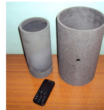
Рисунок 66. Компоненты нагревательных устройств из высокотемпературной металлокерамики
