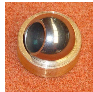
Рисунок 73. Металлокерамический подшипник скольжения
