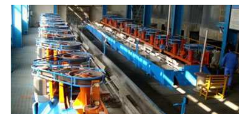
Рисунок 33. Промышленная установка для флотации молибденовых руд
